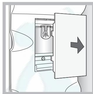
A lámpához úgy fér hozzá, ha az ábrának megfelelő módon levezi a burkolatot. Cserélje ki a védőburkolaton feltüntetett teljesítményű lámpára (10 W).
