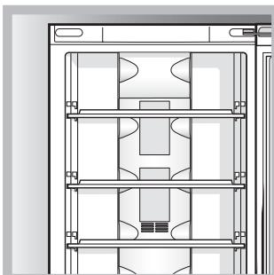
Эта система отличается наличием вентиляционных решеток, расположенных в задних стенках камер холодильника.
